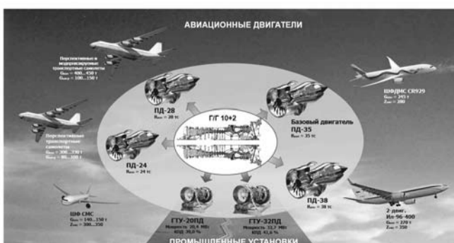
Перспективное семейство двигателей большой тяги на базе унифицированного газогенератора ПД-35
