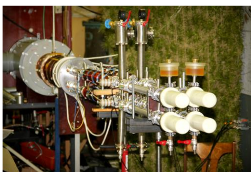
Рис. 17. Генератор наносекундных радиоимпульсов с четырёхэлементной решеткой из спиральных антенн.
