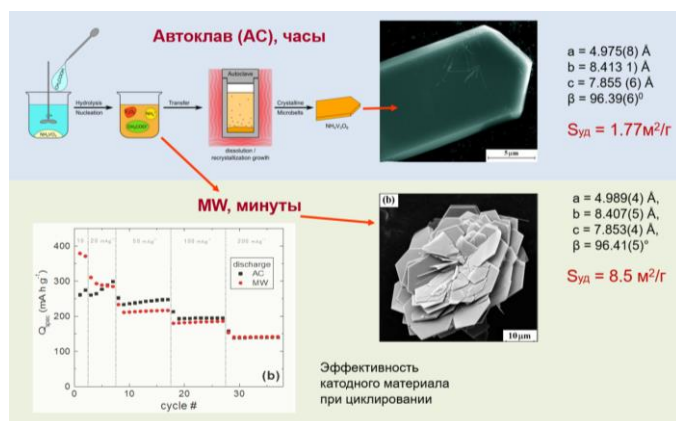
Рис. 54. Получение катодного материала \text{NH}_4\text{V}_3\text{O}_8 с использованием ГТ-МВ технологии.
