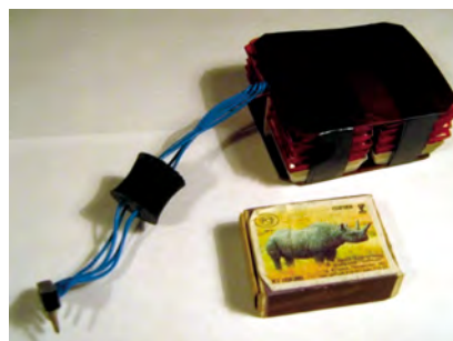
Рис. 61. Опытный четырехсекционный образец батареи с катодом на основе оксидной ванадиевой бронзы меди
