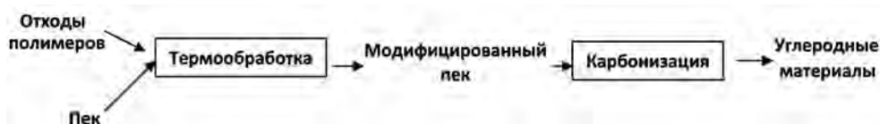
Рис. 57. Схема получения микропористых углеродных материалов для суперконденсаторов, литиевых батарей, сорбентов
