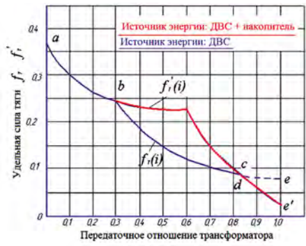
Рис. 29. Зависимость удельной силы тяги на ведущих колесах автомобиля от передаточного отношения трансформатора
