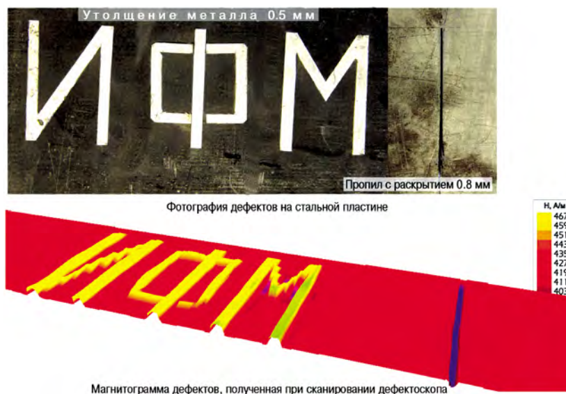
Рис. 32. Фотография дефектов и их магнитограмма, полученная при сканировании дефектоскопа
