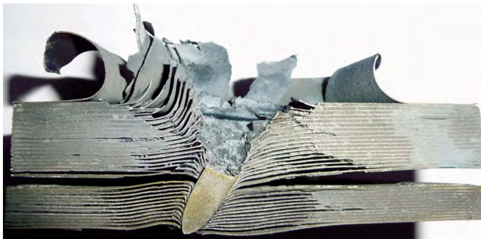
Рис. 15. Фотография слоистого композита Ti– Al_3Ti после баллистических испытаний
