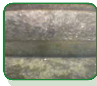
После очистки от меди (1-я стадия). After removal of copper (the first stage).
