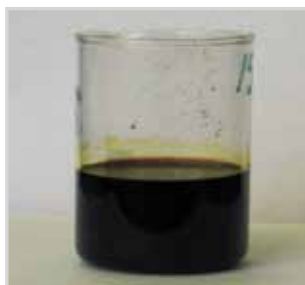
Сточные воды с высоким со- держанием шестивалентного хрома. Waste water with a high content of hexavalent chromium (50 g/l) before purification.
