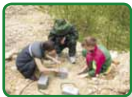
Пример установки сейсмометров при регистрации микросейсмического поля Seismometers installed for recording the field of microseisms
