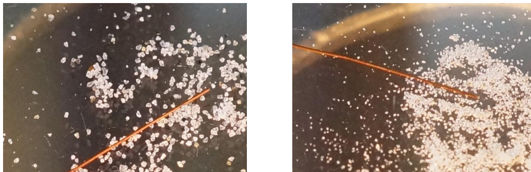
Рис. 2. Кварц после обработки. Справа: фракция более 0,25-0,315 мм. Слева: фракция 0,16-0,25 мм. Диаметр проволоки – 0,2 мм
