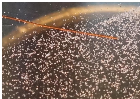
Рис. 3. Кварц после обработки. Справа: фракция менее 0,16 мм. Диаметр проволоки – 0,2 мм
